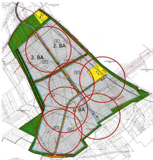
Abbildung 32: Übersicht Löschwasserversorgung mit Löschwasserbehälter 34 (Quelle: LEG )
